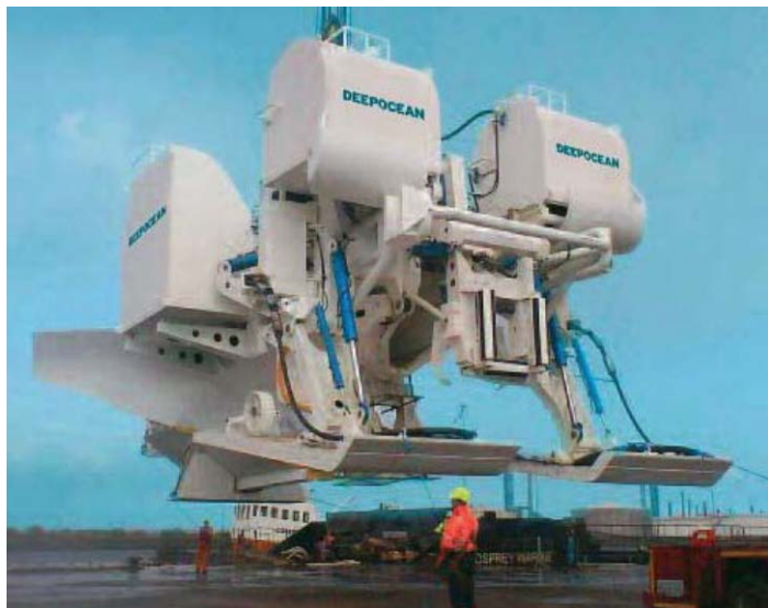
Рис. 8 Специальное устройство для создания кабельной траншеи на глубинах 10 – 30 м
