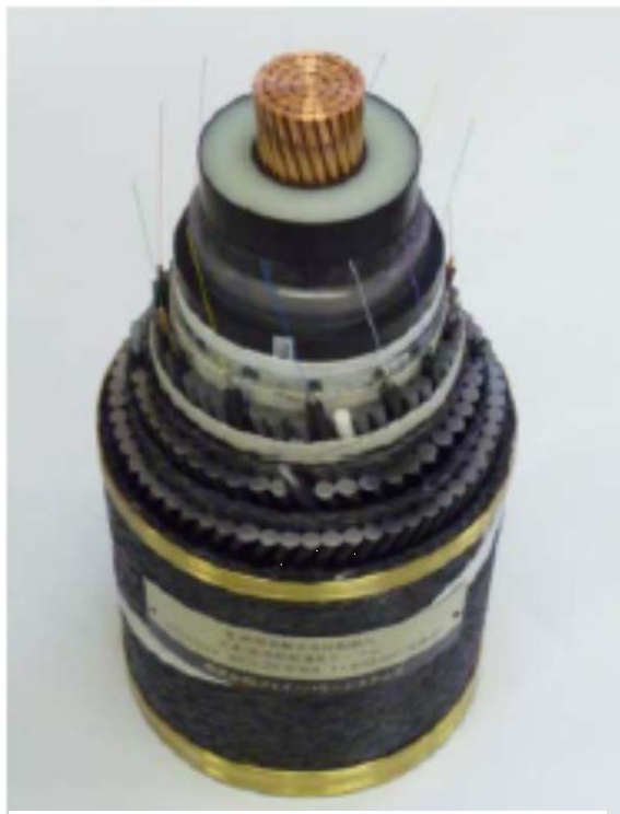
Рис. 6. Внешний вид подводного кабеля DC \pm 250 кВ
