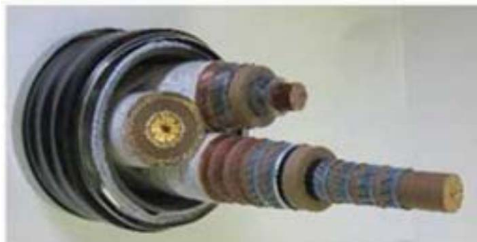
Рис. 18 Внешний вид кабеля 66 кВ на основе высокотемпературной сверхпроводимости, проложенный в Йокогаме (Япония).
