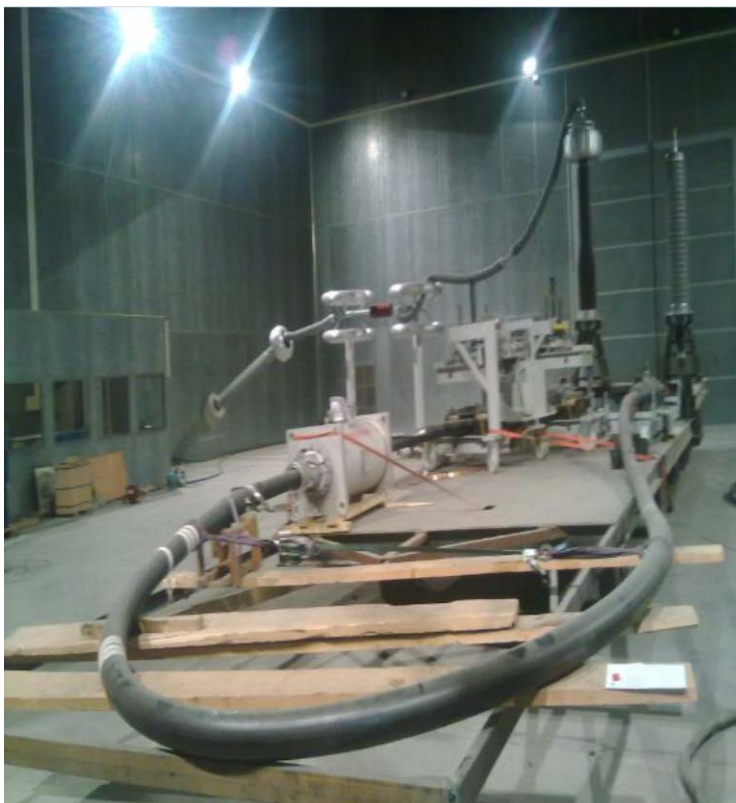
Рис.11. Типовые испытания кабеля на напряжение 220 кВ
